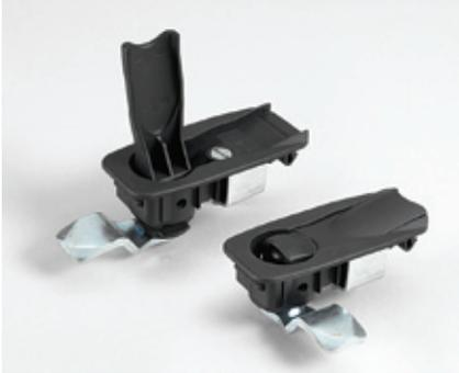
混合式提转系列门锁是一种适用于轻载和中载应用的门锁，其主要部件使用工程塑料制造，能减轻重量并保持良好的强度。当杠杆处于直立位置时，可旋转 360 度以将支柱后的锁舌任意转动 90 度。一旦转动到位，杠杆合闭并与锁套齐平，提供 5 毫米的轴向拖曳且通过偏置动作以锁定门锁。
