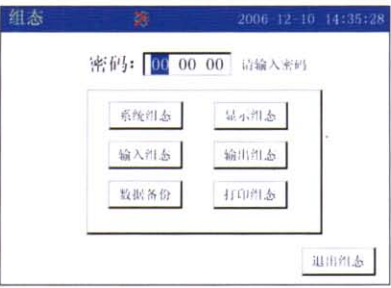
组态显示：管理员密码保护，增强系统的安全性 各项功能参数的设置由管理人员操作
