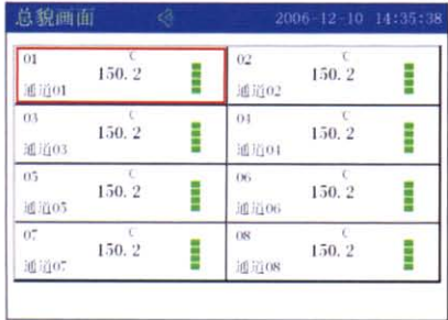
总貌显示：工程测量数字显示报警灯指示报警状态
