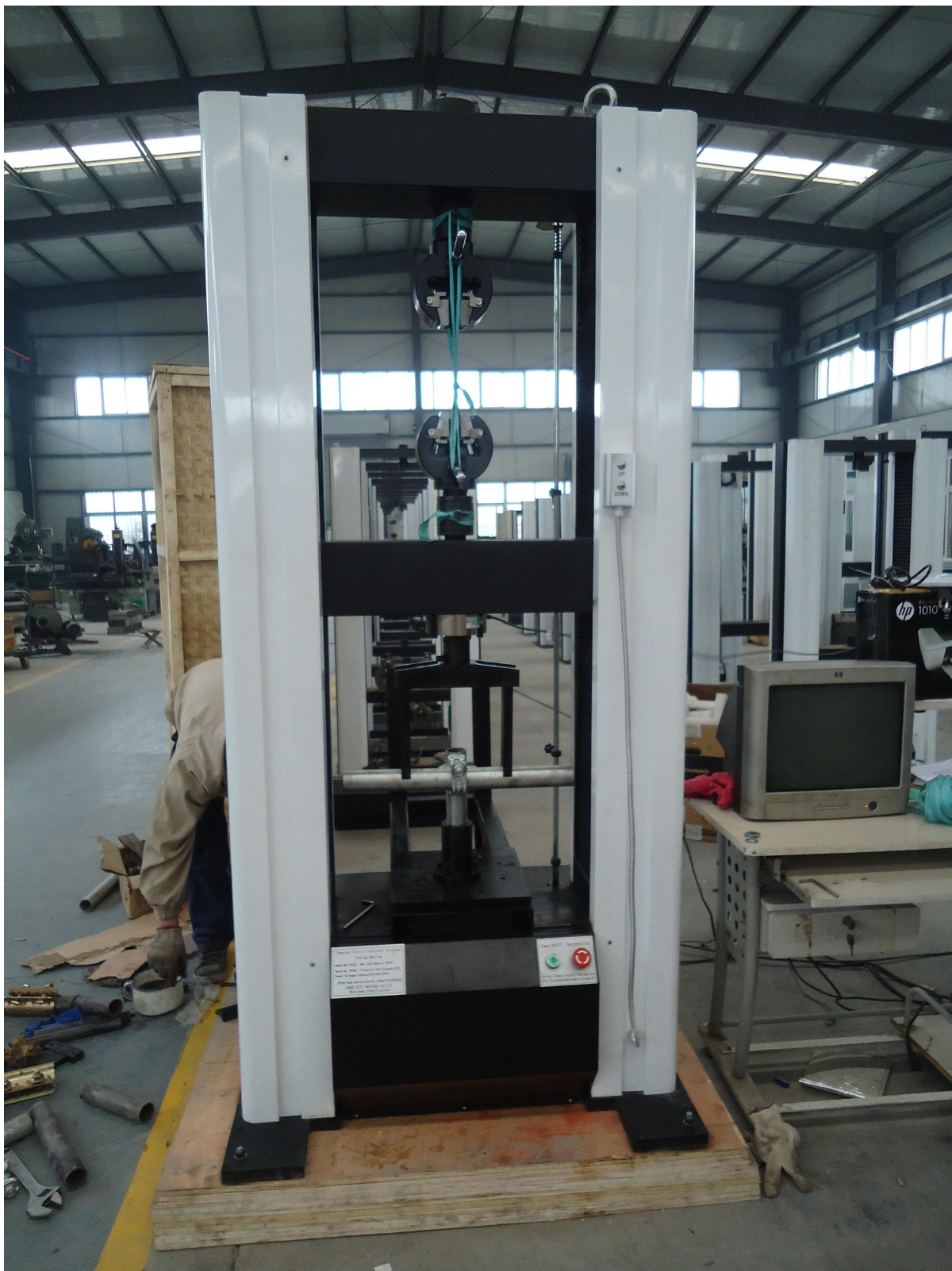
脚手架扣件试验机现场图片
