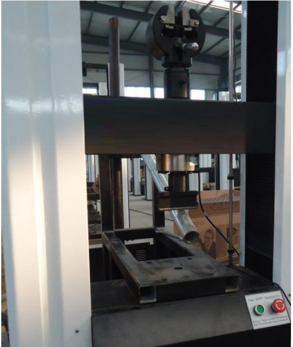
直角扣件的十字抗弯试验
