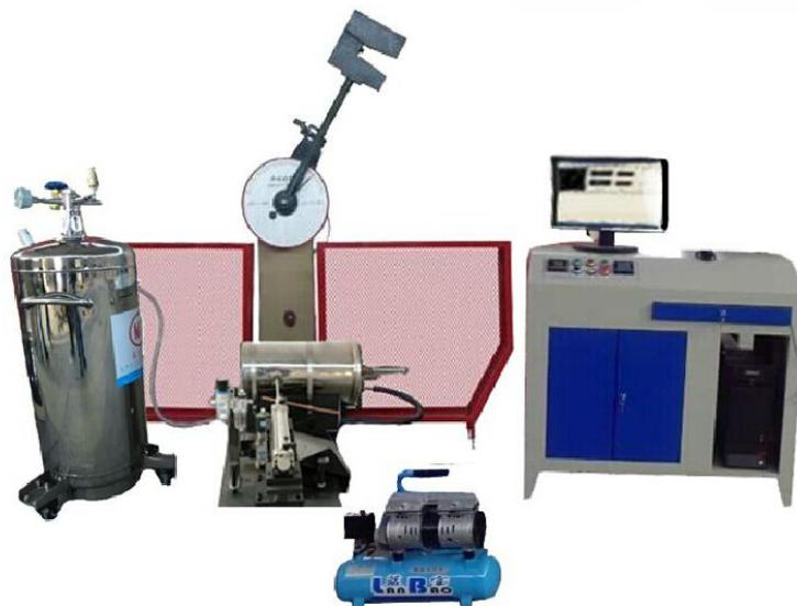
一、 设备名称：微机屏显超低温全自动冲击试验机
