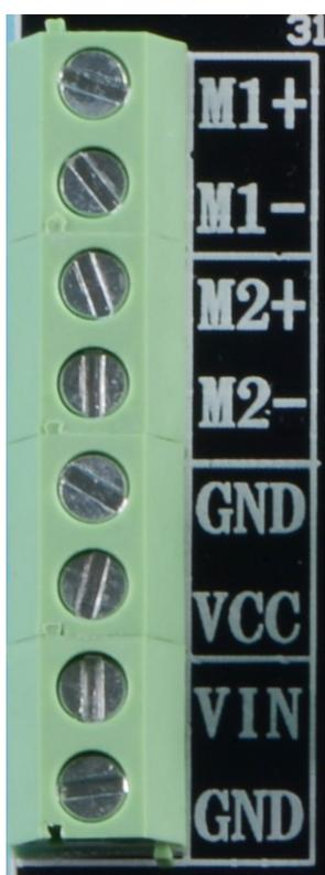
左图 M1+, M1-是接一个直流电机的接口，电流不可超过 2A，M2+, M2-是接另一个直流电机的接口，电流也不可超过 2A，VCC 是输入电压的输出，由外接电源开关控制，VIN 是外接电源的输入 6-12V，（2 节锂电池串联后，接在此接口，可以通过 DC 座的，外接电源给电池充电，充满电压 8.4V，其他电池不可充电）。
