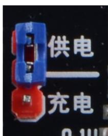
此跳线默认是设置 DC 座供电的功能，默认设置为 DC 座给主板供电，跳到另一边则是 DC 座供电给电池充电，VIN 接 2 节串联的锂电池，充满电压是 8.4V，其他的电池是不能充电的，给电池
