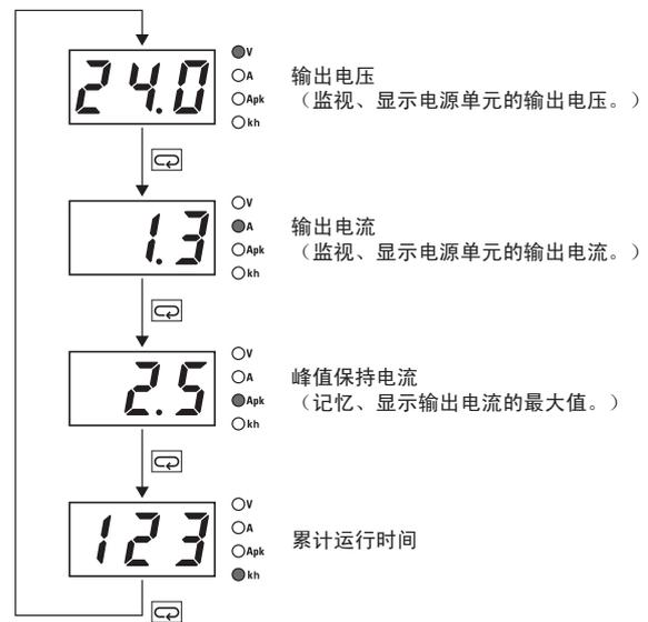
注1. 峰值保持电流在电源启动3秒后才开始测量，故无法测量负载的冲击电流。
