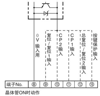
注：转速表使用时，CP2输入、总复位/复位2输入不使用。
