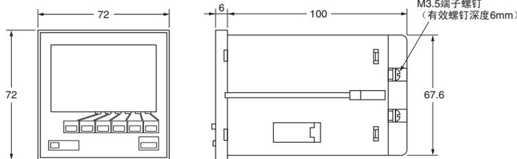
注: 端子螺钉为M3.5。(有效螺钉深度6mm)
