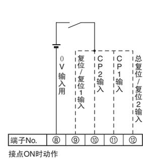
注：转速表使用时，CP2输入、总复位/复位2输入不使用。
