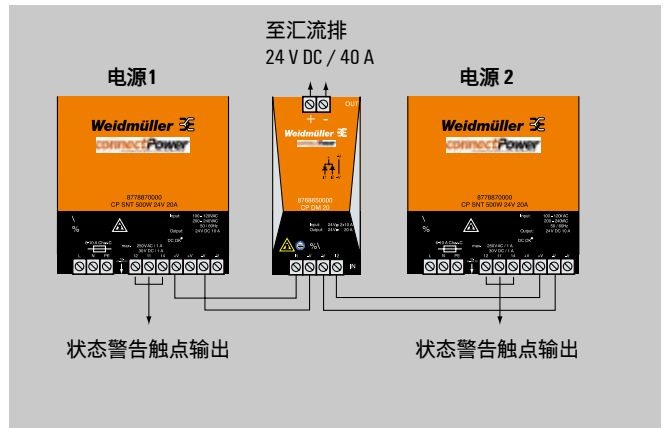
图(4)两台40 A电源并联
