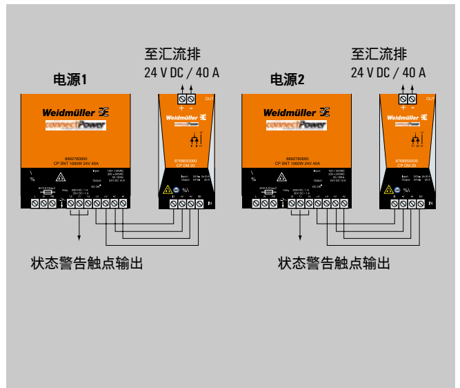
图(4)两台40 A电源并联
