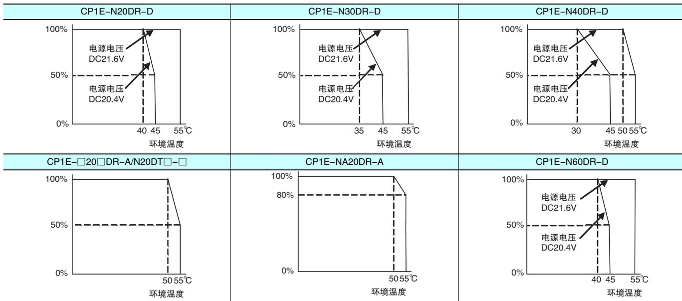
注. 即使不增设扩展I/O单元，CPU单元的继电器输出负载电流同样受到上述限制。
