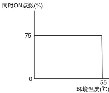
扩展I/O单元(CP1W-8ER/16ER/20EDR1/32ER/40EDR)与CPU单元组合使用时，根据环境温度，对电源电压和输出负载电流有限制。
