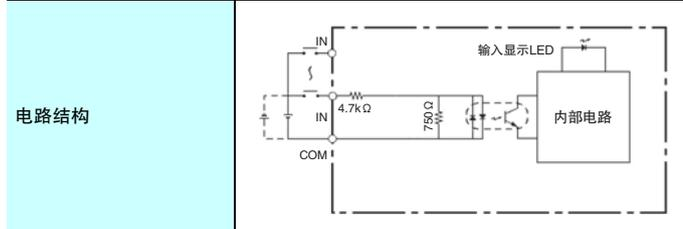
注. 请不要在输入端子上施加超过额定电压的电压。
