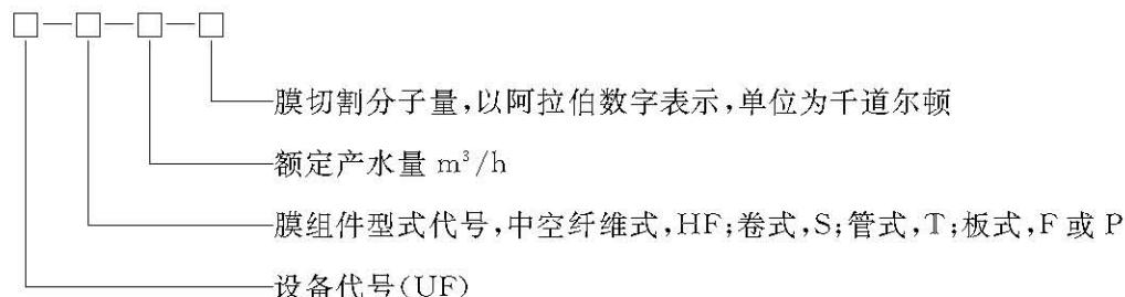
4.3 型号示例:采用中空纤维式膜组件、设备额定产水量为  $8 \text{ m}^3/\text{h}$ 、膜切割分子量为 60 千道尔顿的超滤水处理设备型号表示为: UF-HF-8-60。
