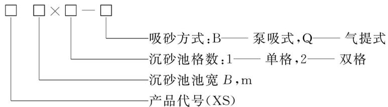
示例：沉砂池池宽 6 m，双格池，泵吸式吸砂机标记为：XS 6×2—B。
