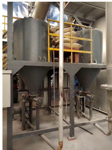
图 7-2 石灰/活性炭喷射脱酸
