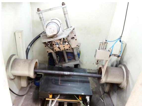
图 6-4 X 射线探伤机
