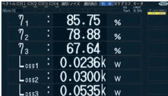
利用有功功率值、马达功率值只用 1 台同时确认变频器 / 马达各自的效率 / 损耗 Loss[W] 和综合效率。
