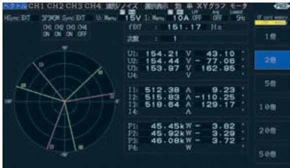
各谐波次数的电压 / 电流 / 功率 / 相位角可用矢量图及数值进行确认
