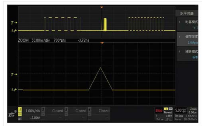
1.4M存储深度下,采样率降低到20M,波形已经完全失真
