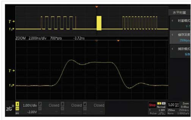
28M存储深度下,采样率保持在1G,波形细节清晰可见
