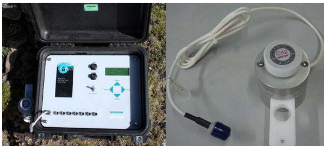
图2.9 WESCOR PSYPRO植物水势测定系统和C-52探头。
