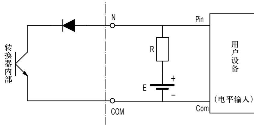
b、上、下限报警OC输出接线图：
