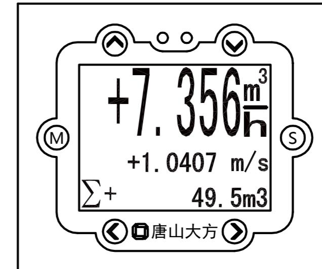
6.1.2 显示界面示意图(在主显示界面下按“ $\wedge$ ”、“ $\vee$ ”键切换显示界面)
