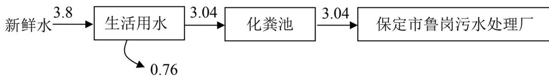
图 2-1 研发大楼平衡图 单位  $\text{m}^3/\text{d}$
