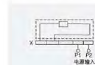
外挂欠电压模块接线图（虚线框内为断路器接线图）
