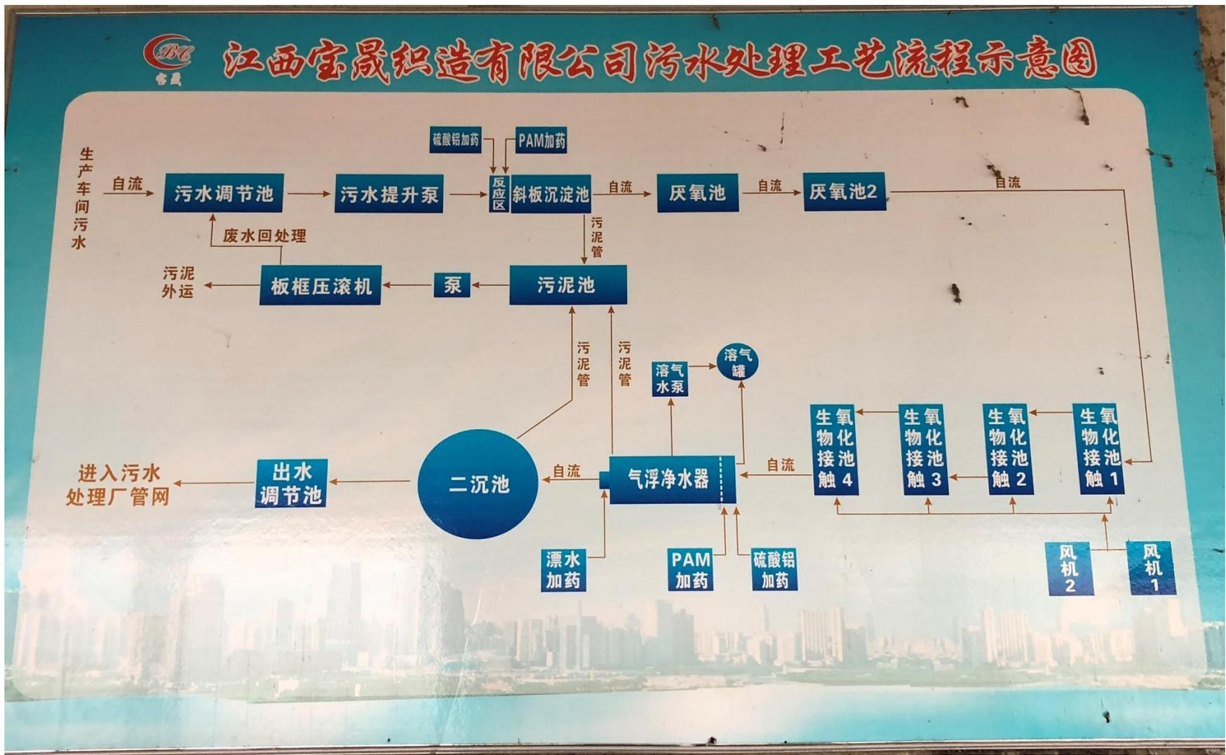
图4-1 污水处理站工艺流程图
