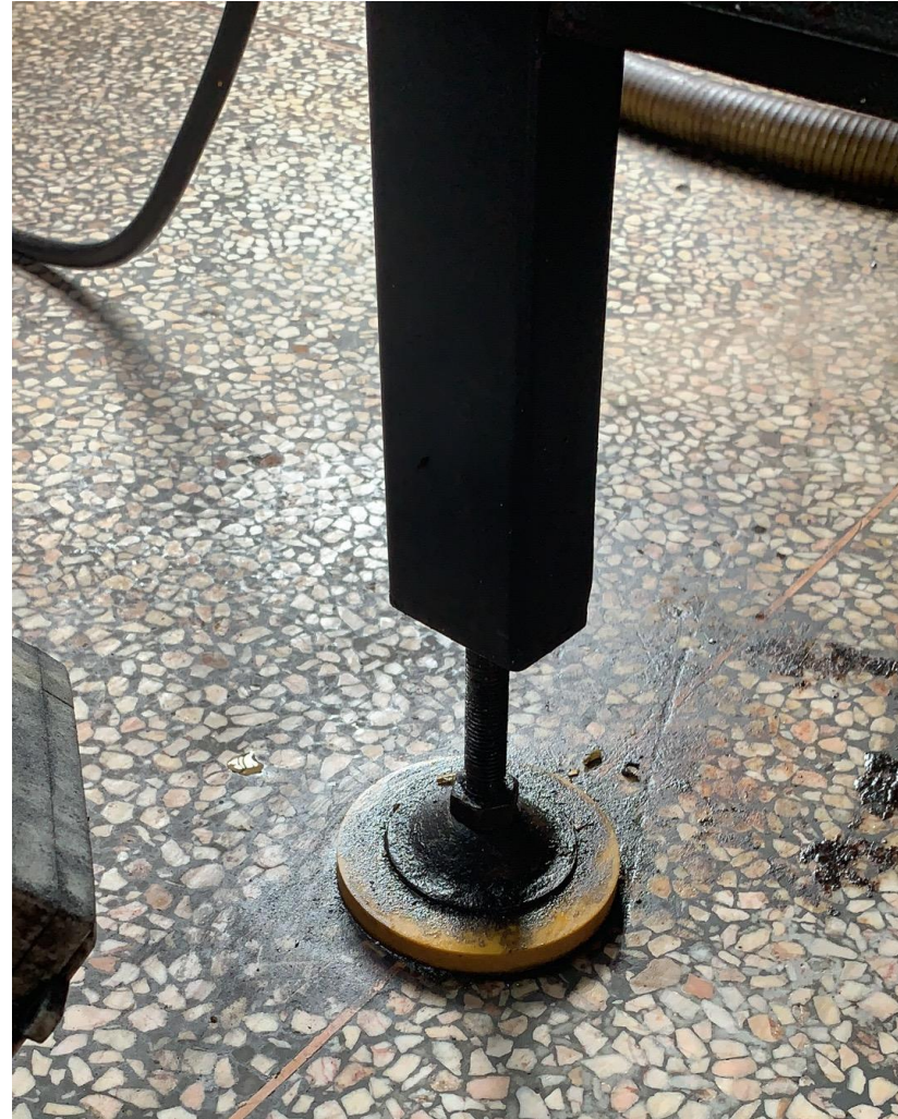
附图 6 设备减振垫
