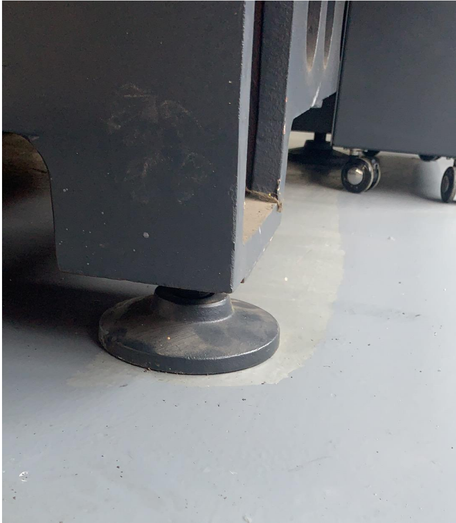
附图 6 设备减振垫
