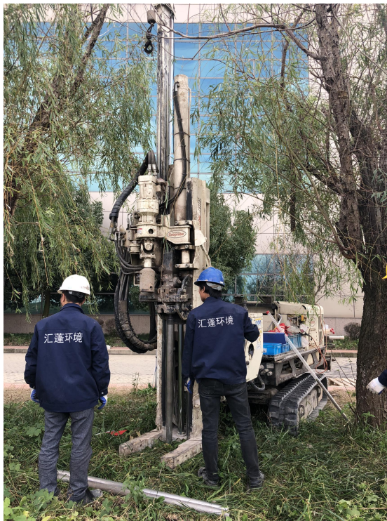
图 5-2 土壤采样过程
