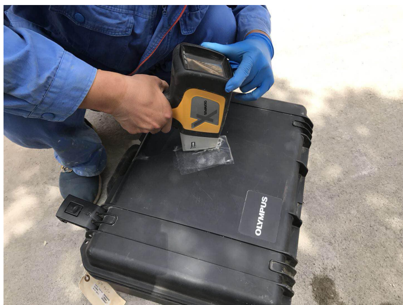
图 5-4 重金属污染物 XRF 快速检测
