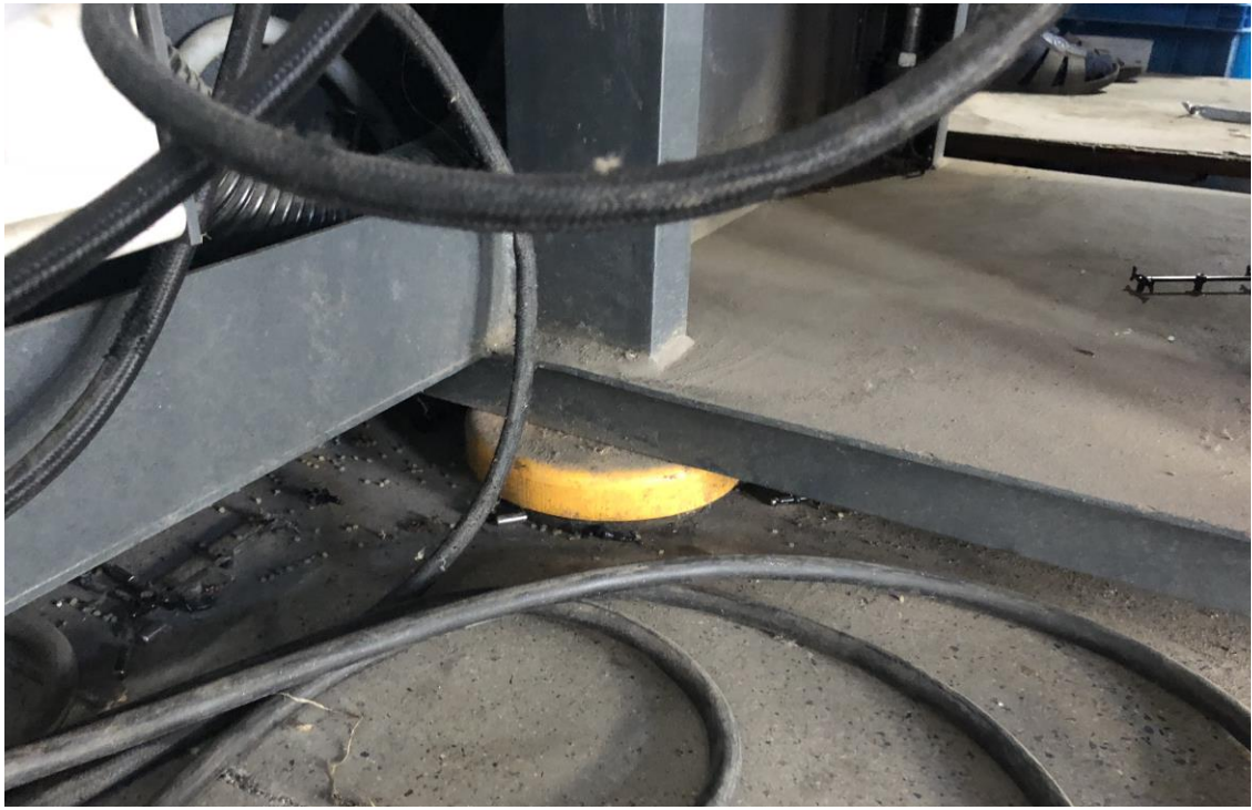
附图 4 设备底座采取减振措施
