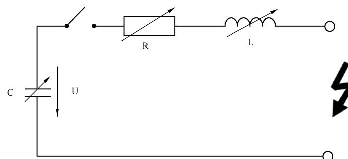
图 F.2 雷电流发生器原理图
