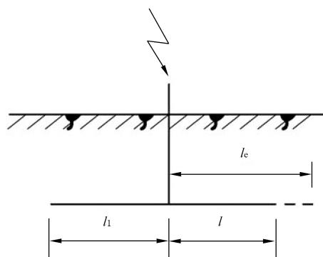
c) 多根水平接地体,  $l_1 \leq l$
