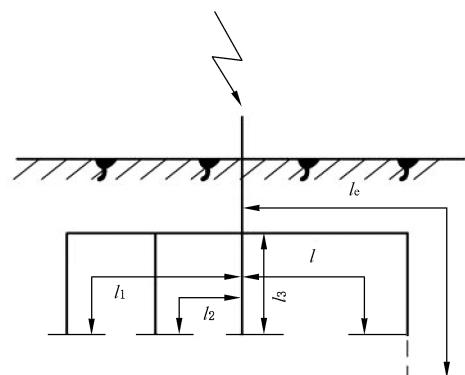
d) 接地根垂直接地体的多根水平接地体,
