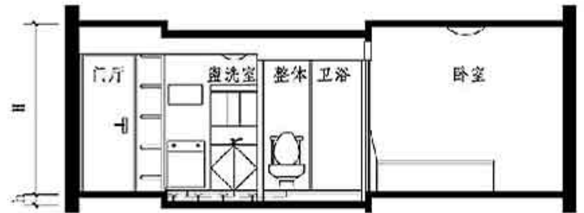
图10 SI住宅体系排水方式示意图（降板）
