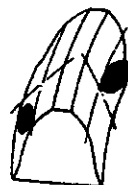
图 3-31 齿轮不正确接触印痕 图 3-32 齿轮不正确接触印痕
