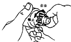
图 4-50 检查齿轮旋转方向
