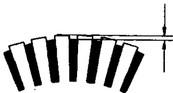
图 4-45 测量云母槽深度
