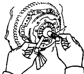
图 3-6 检查膜片弹簧内端是否在同一平面
