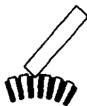
图 4-46 用锯条修整云母槽
